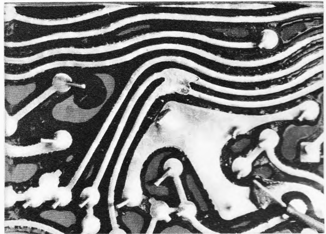
Ein fabrikneuer Fernsehempfänger wies eine falsche Lötverbinding zwischen zwei Leiterbahnen auf (Bildmitte). Außerdem mußte noch die mangelhafte Isolierung des angelöteten Drahtes (unten rechts) verbessert werden.
