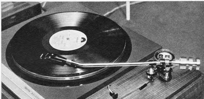
Bild 1. Halb- professionelles Plattenlaufwerk mit zwei Laufgeschwindigkeiten (Modell TTS-300/PUA-237)
